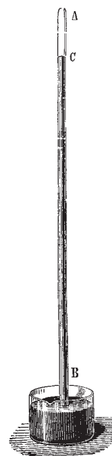
Ртутный барометр Эванджелисты Торричелли. Над поверхностью ртути в верхней части запаянной трубки (в области AC) – вакуум («торричеллиевая пустота»)
